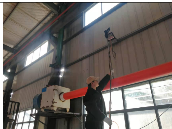
活性炭吸附装置进口采样照片
